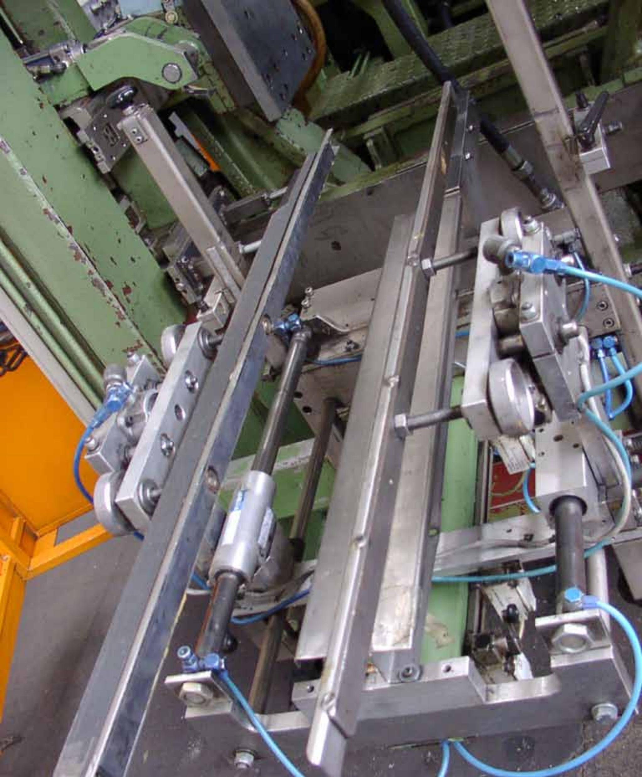
Entnahmeschlitten / take out gripper
